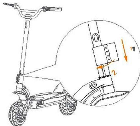
*Poznámka: upevňovací mechanismus musí být dobře utažen. Pokud máte pocit, že páka mechanismus zcela neutáhla, postup opakujte!*
